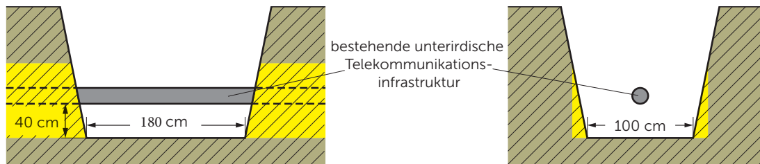
Abb. 7 Abmessungen der Anschlussgrube für unterirdische Anschlüsse
